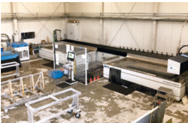
Neu im Maschinenpark: die Wasserstrahl-schneideanlage »brembana easyline« von CMS Steintechnik
